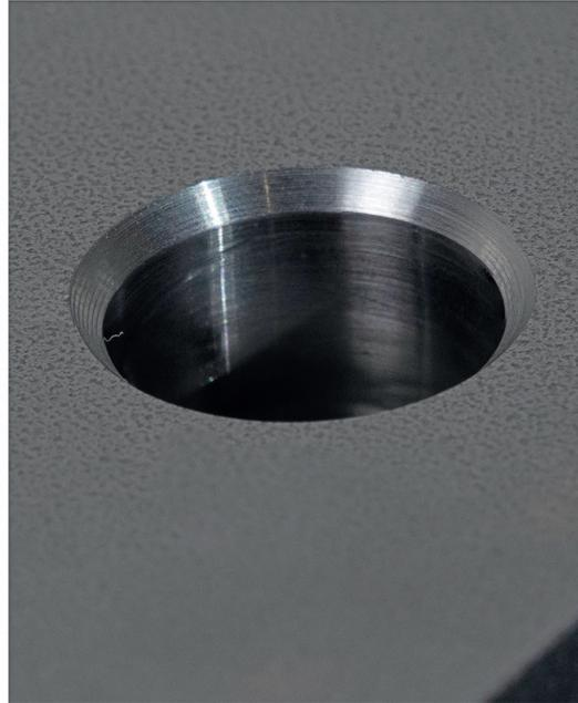
1 So sollten sie aussehen: reproduzierbare Entgratergebnisse an Bohrungen in der Serienfertigung. Erzielt wurden sie hier mithilfe mechanischer Entgratlösungen
