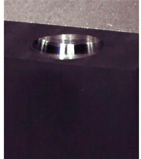
3 Mechanische Entgratlösungen mit beweglicher Schneide wie hier das Werkzeug 'Cofa' des Entgratspezialisten Heule liefern fertig entgratete Werkstücke direkt von der Maschine © Heule
